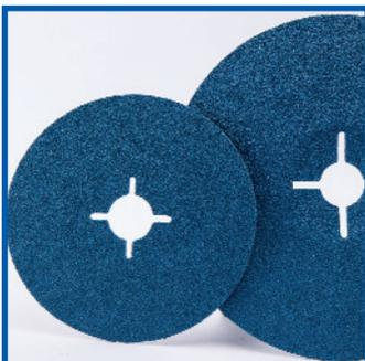
Disco di elevato rendimento che, grazie alle proprietà autoaffilanti dello zirconio, risulta ideale nella lavorazione di acciai inossidabili e acciai legati. Va montato sulla smerigliatrice angolare tramite apposito platorello e ghiera di fissaggio.
